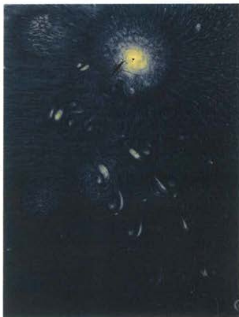
図4 アメロボが水面で脚をこくように動かすと、1ストロークごとに水中に一对の渦ができる。底面から照明をあて、pHに反応する色素テモールブルーを水に添加して渦を可視化した。上方にある大きな色素の塊が、雲間から差し込む太陽光のようだ。
