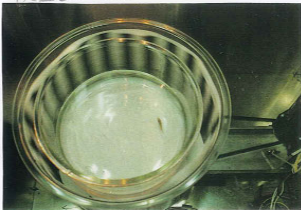
図9 追従装置による視覚検査。ある速度で回転する白黒の縞模様、メダカが追従できるかどうかで検査する。
